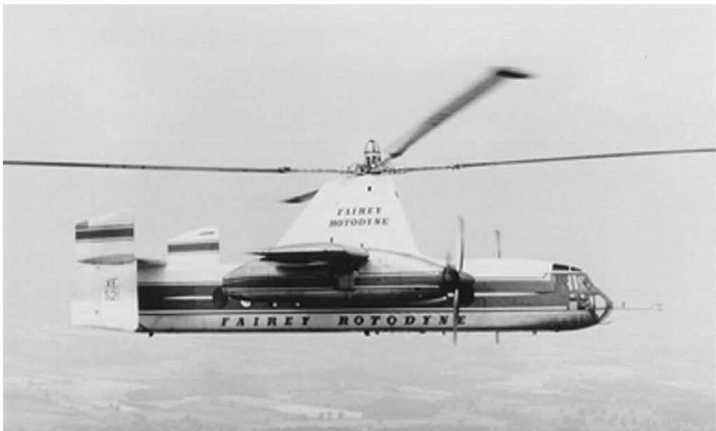
写真1 4枚あるプロペラの1枚に、ティップ・ジェットが見える。こうした大型の航空機は、ジェット機とヘリコプターに押されて、現在ではほとんど利用されることはない。
